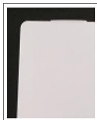
バリの発生する要因は2つです。元々の金型の隙間が大きかったか、充填圧を上げた為に金型が押し開かれ、その隙間に入り込んで出来たものです。
