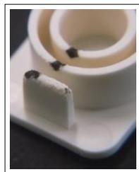
ガス焼けは、金型の充填圧を上げ続けていくうちに、排気が困難になった最終充填箇所の空気の温度が、対象材料の発火点を越えたときに起きます。材料の発火点を越えないようにするには、ベントを増やすことです。
