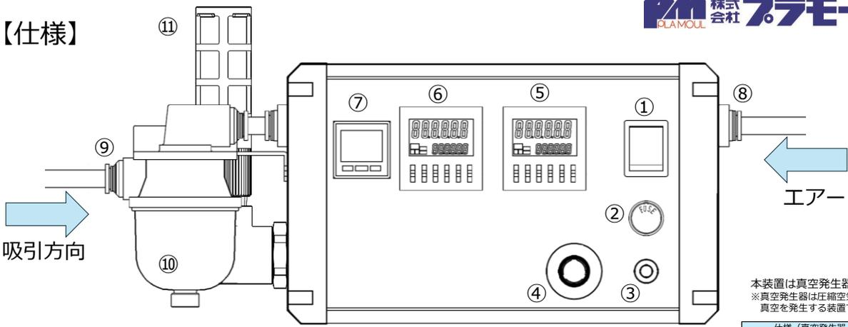
本装置は真空発生器搭載の吸引装置です。
